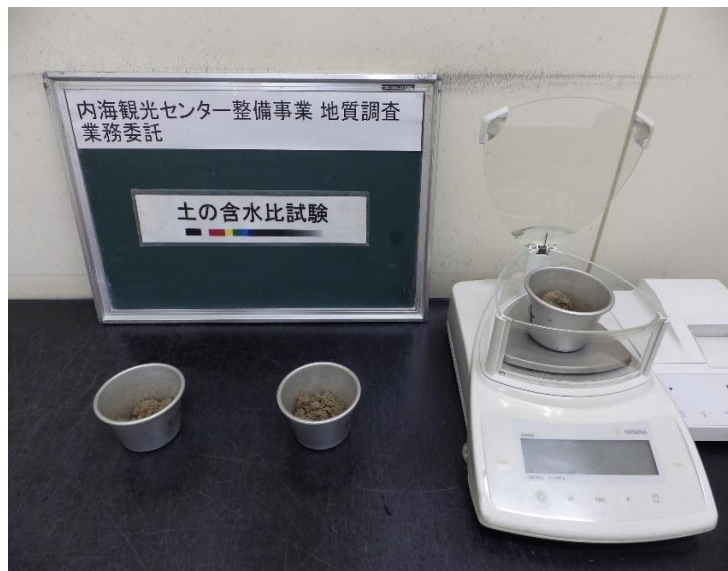
土の含水比試験
