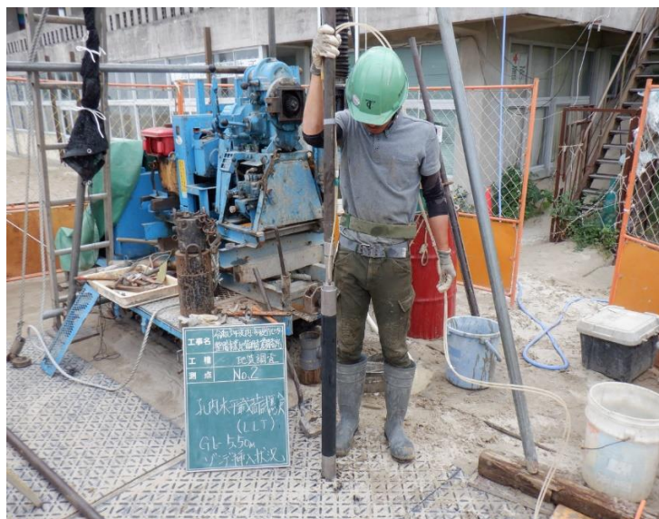
孔内水平載荷試験
