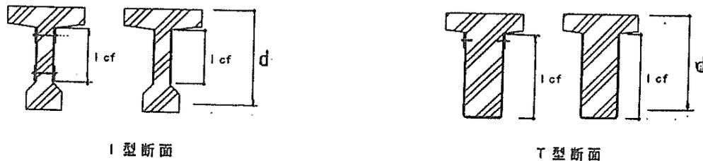
図一解 3.4.4 貼付け長  $l_{cf}$  の考え方
